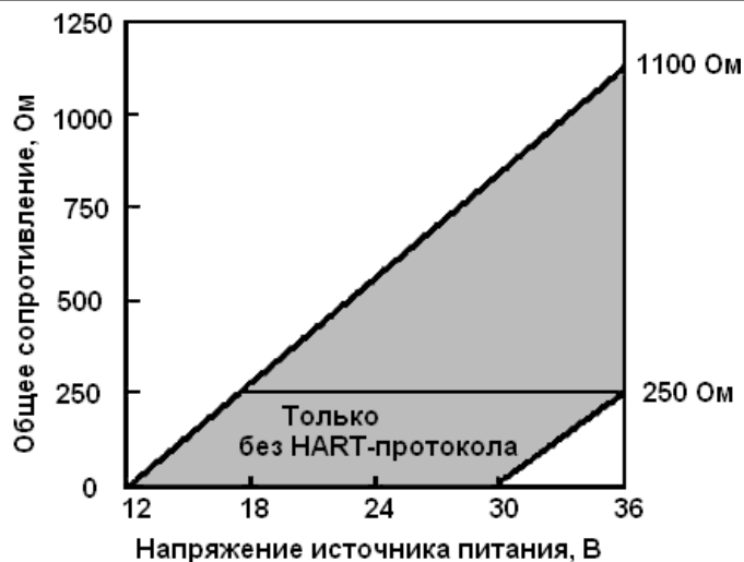
Рисунок 6 – График зависимости допустимого напряжения питания от общего сопротивления системы.
